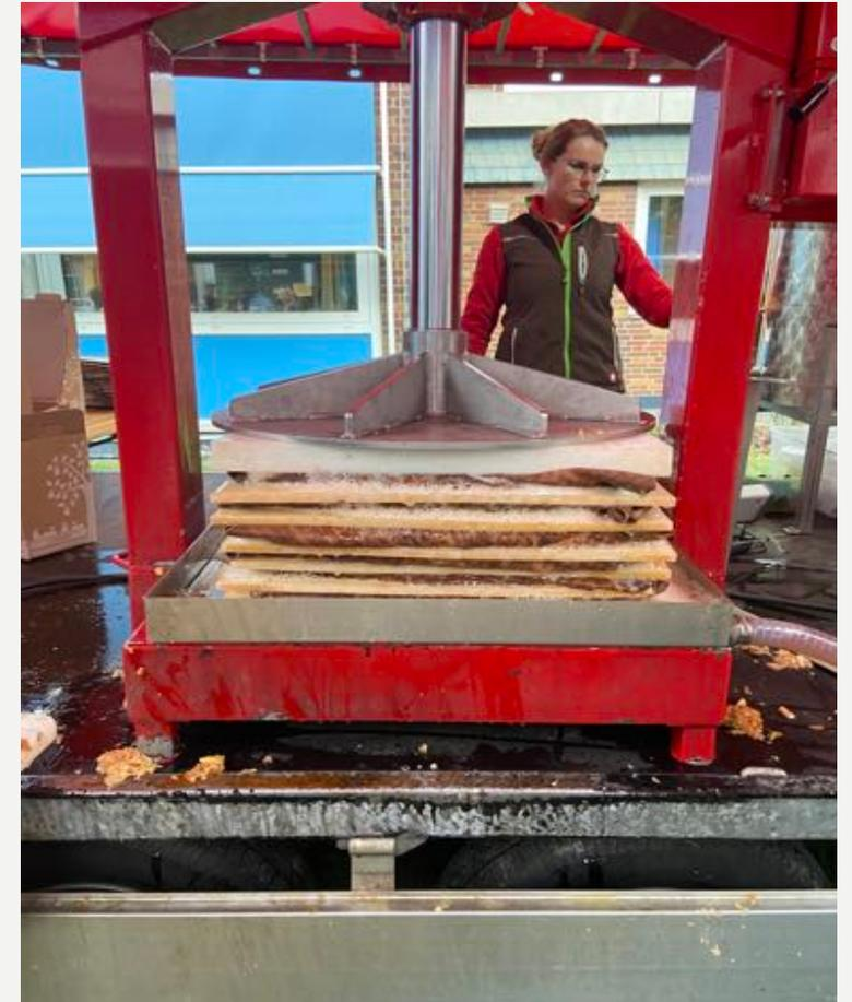
Die Äpfel werden mit 330 Bar gepresst, der Prozess dauert 10 Minuten.
